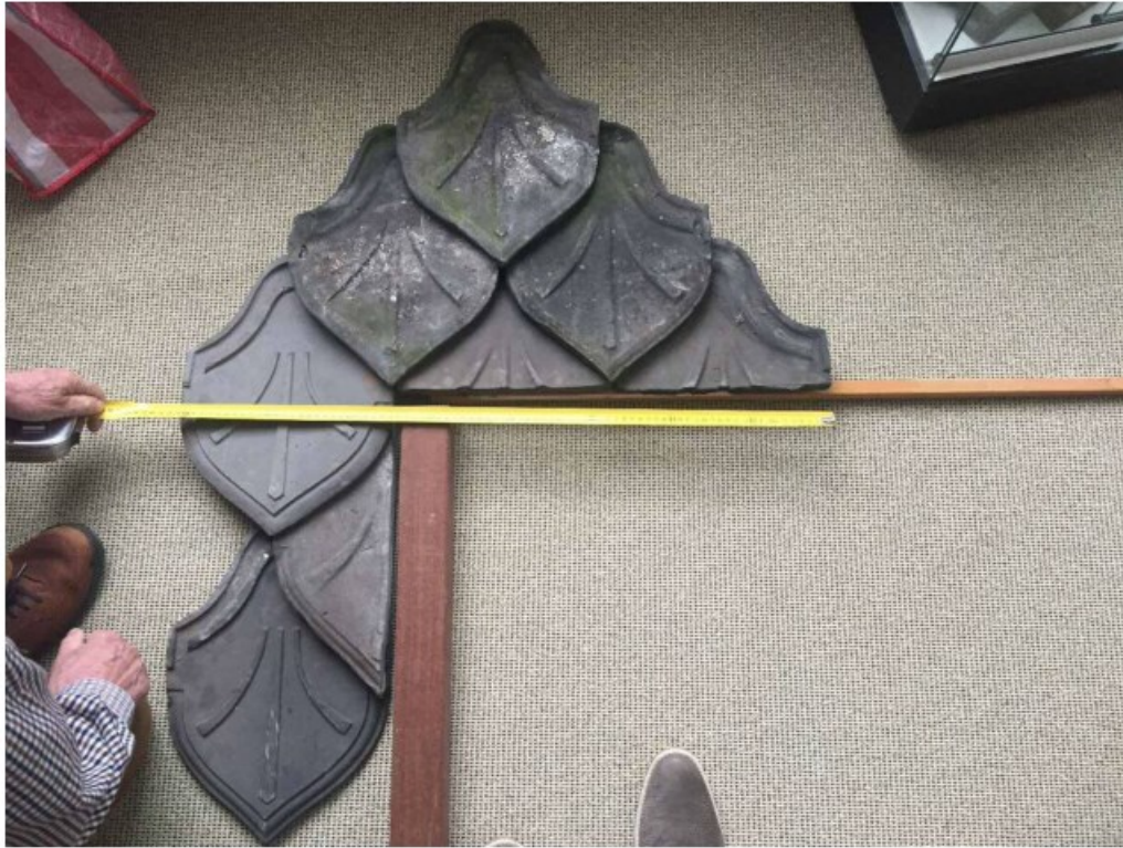
Foto verband en werkende breedte Oestgeester pan
